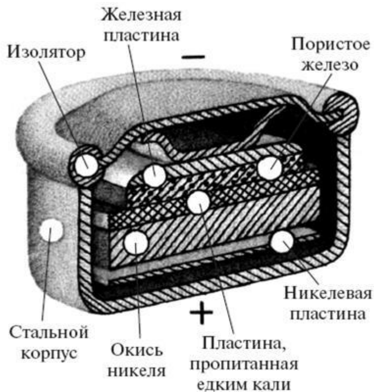
Рис.3 – Щелочной кнопочный аккумулятор
