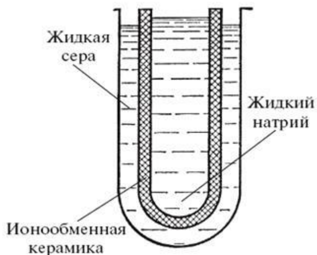
Рис 2 - схематическое изображение «горячего» серно-натриевого аккумулятора.
