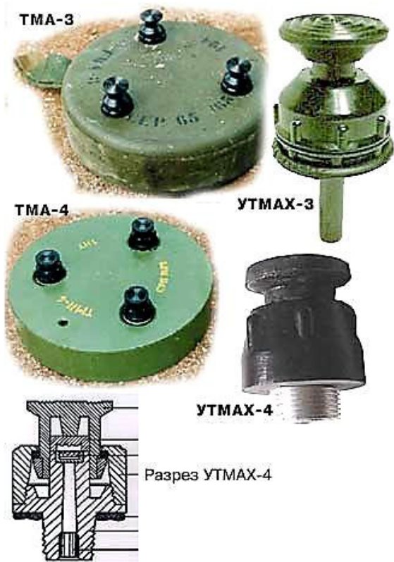
ФОТО 103. Противотанковые мины ТМА-3 и ТМА-4 // Сайт Ю.Г. Веремева «Сапер» / www.etel.ru/~saper
