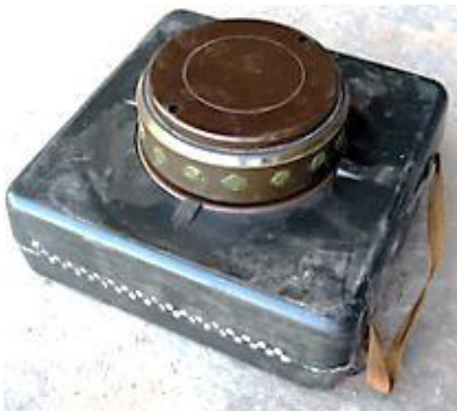
ФОТО 94. Противотанковая противогусеничная мина PRB M-3 // Колин Кинг (Colin King. Landmines in Libya. Fenix-Insight Ltd.)
