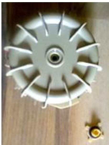
ФОТО 19. Нижняя часть итальянской противопехотной мины фугасного действия VS-50 // Найден Илиев
