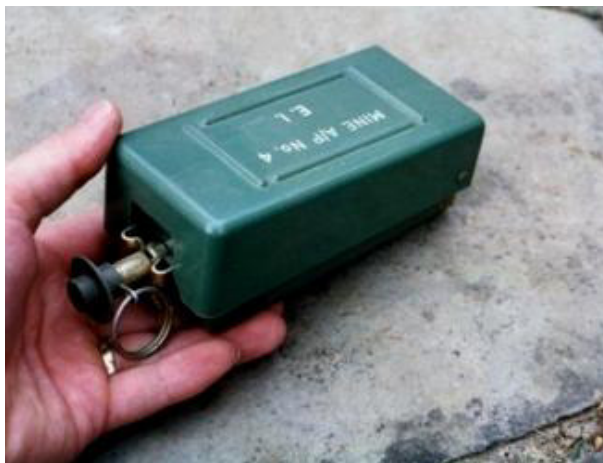
ФОТО 1. Израильская противопехотная мина фугасного действия № 4 // Mine Clearance 1999-00. Jane's Mines and Jane's Information Group Colin King [справочник]
