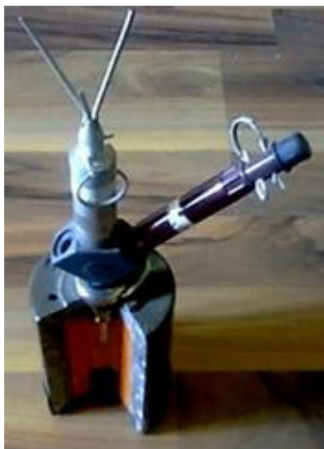
ФОТО 9. Учебная выпрыгивающая противопехотная мина осколочного действия ПСМ-1 // Найден Илиев
