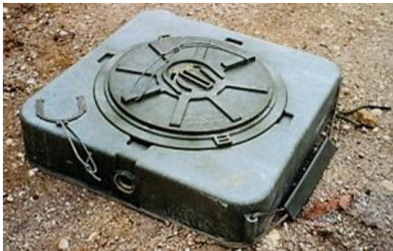
ФОТО 85. Противотанковая противогусеничная мина М-19 производства США // Mine Clearance 1999-00. Jane's Mines and Jane's Information Group Colin King [справочник]
