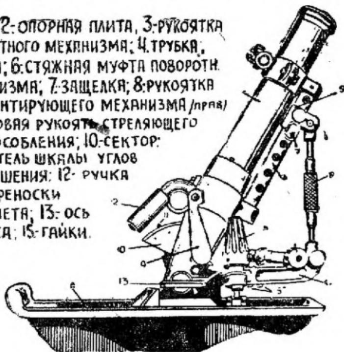
ным и горизонтирующим (выравнивающим) механизмами, уровнем и рамой для соединения ствола с опорной плитой.
