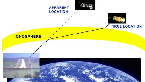
Fig. 6-11. Surveillance Radar Errors
