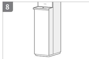
8 前面カバーを上からスライドさせて閉じた後、受け皿を再度取り付けます。
