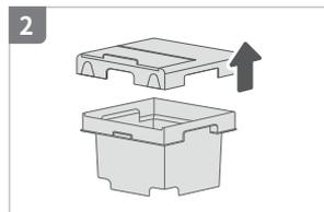
タンクカバーを前後にある爪を外しながら上に引き上げて外してください。
