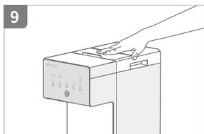
タンクカバーの上部を軽く押して、タンクが浮いていないか確認してください。
