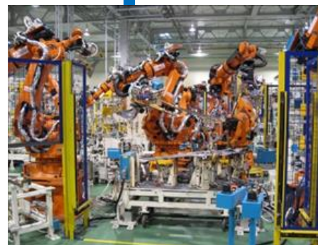
④ロボット溶接機による溶接組立
