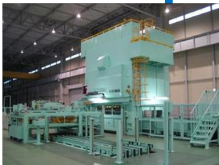
②ブランキングプレス機による鋼板の切り出し
