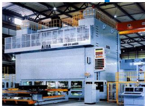
③トランスファープレス機による自動プレス加工
