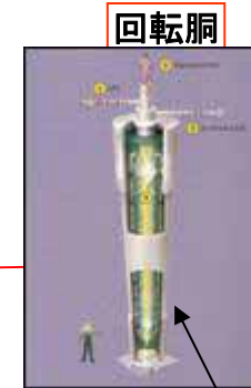
軽量高剛性により 高速回転を実現 ウラン濃縮回転胴
