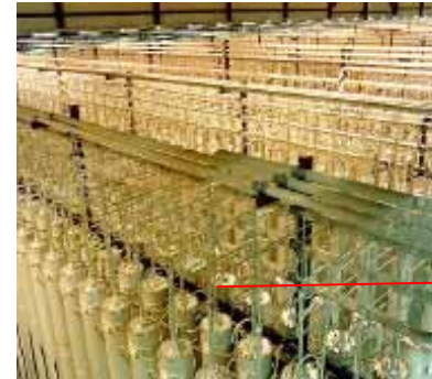
軽量高剛性により 高速回転を実現 ウラン濃縮回転胴
