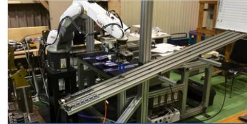
コンベア上からカメラで部品の位置確認を行い自動で部品取出し
