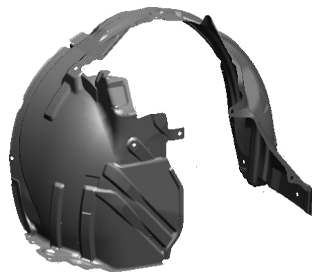
フロントフェンダープロテクター
