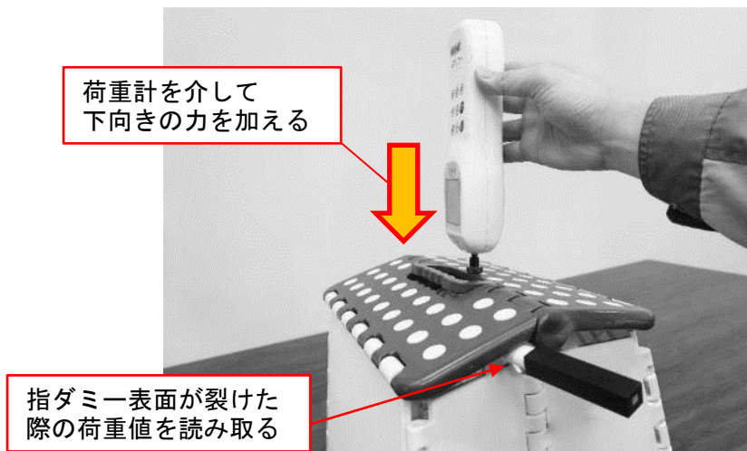
写真14. 指ダミーの裂けた際の天板への荷重測定
