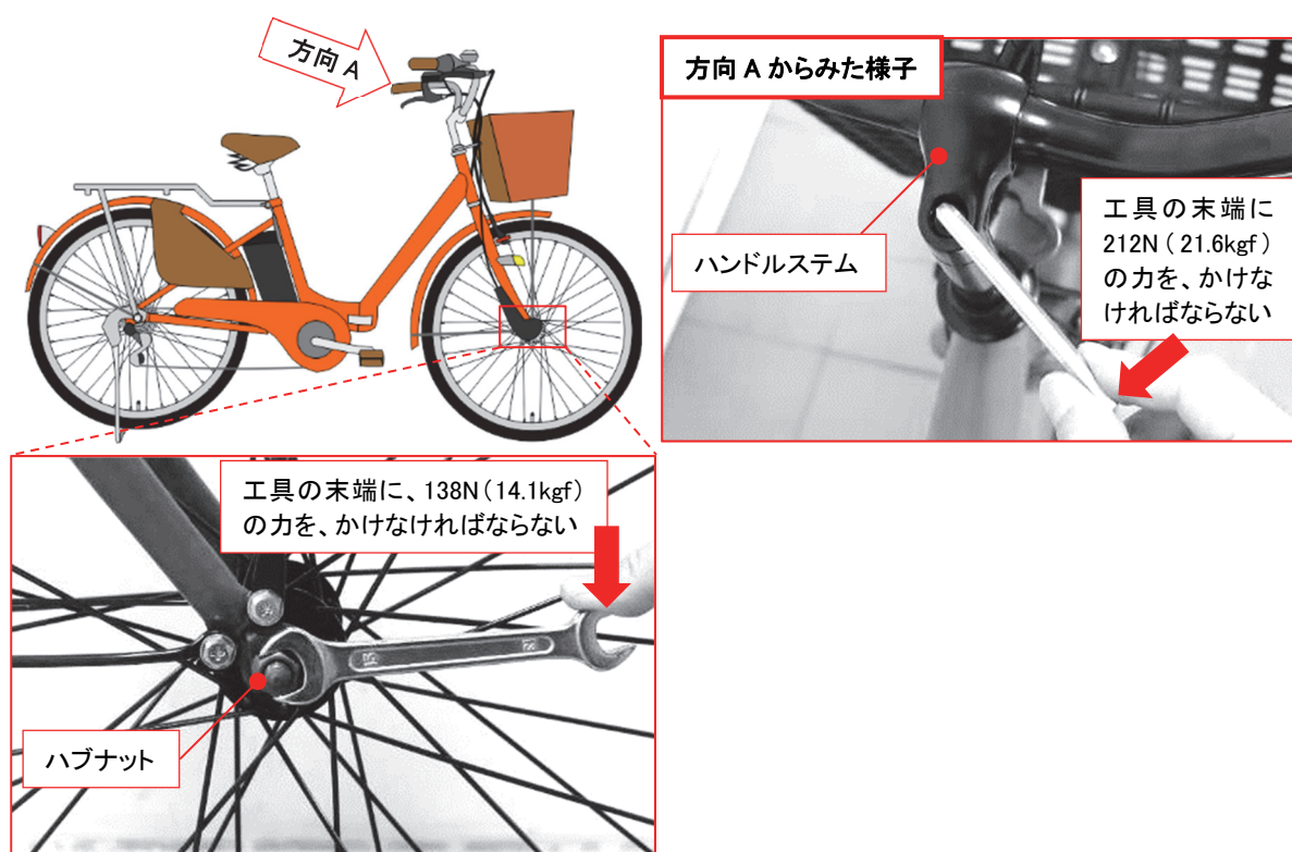
写真 5. 付属の工具での締め付けの一例
