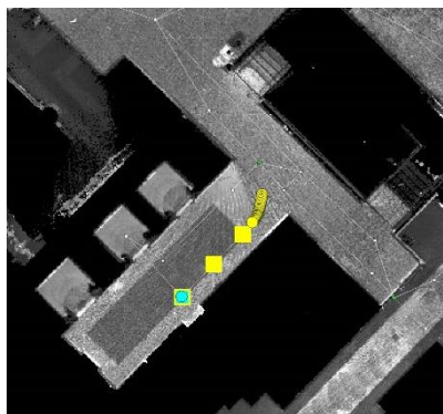
③SBロボットはエレベータ乗車を待機。DN-3ロボットは2番目のノードを占有して進行
