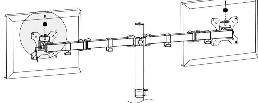
下図に示す関節の角度と固さ、モニターの高さを六角レンチ大⑫でお好みに調節できます。
