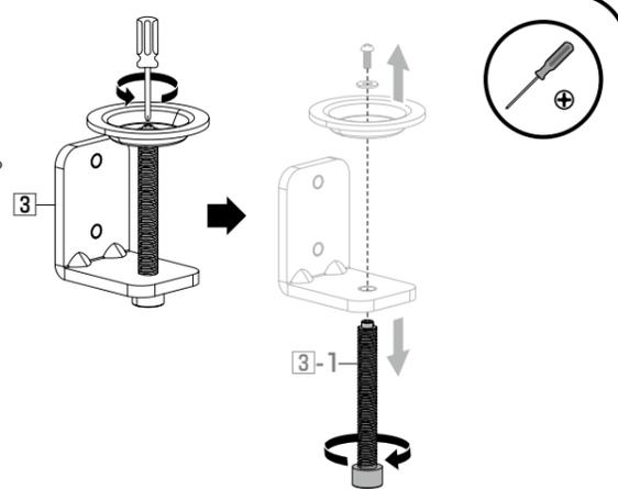
② 図のようにグロメット用プレート⑥、ベース⑤、ジョイント⑦に六角レンチ大⑨でボルト③-1を固定します。
