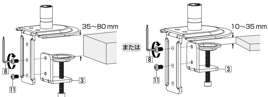
③ デスクにクランプを奥まで挿し込み、六角レンチ大⑨でボルト③-1を回してしっかりと締め付けて固定します。
