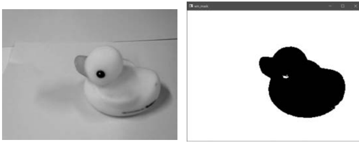
図 1.6 ●クロマキー合成用前景（背景は緑）と自動生成されたマスク
