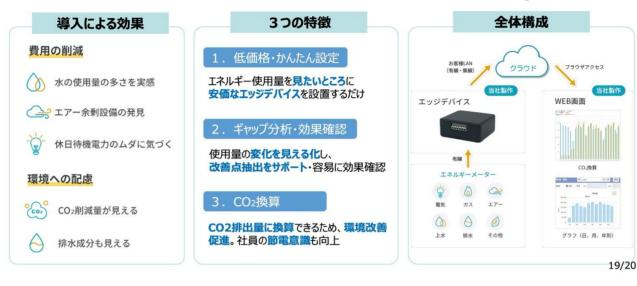
5月に発売を開始したエネグラフは、メーターから使用量データを収集するエッジデバイスとアプリケーションを開発することで、電気やガス、エアー、水などを利用する生産設備から使用量データを収集し、クラウドを通じてリアルタイムに見える化をすることができます。
