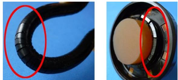
図：経年劣化でヒビ割れが発生した様子
