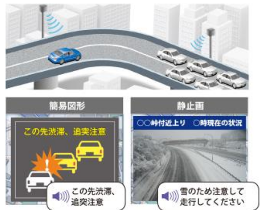
車載モニターに表示される ETC2.0 の安全運転支援情報
