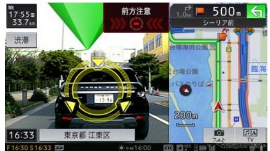
ターゲットスコープで警告前方車両の接近を警告。パイオニアサイバーナビの安全運転支援機能（マルチドライバアシストユニット ND-MA1 との接続が必要）
