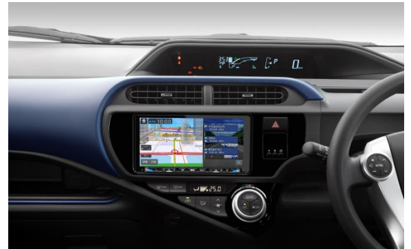
インパネのオーディオスペースに装着するオーディオ一体型ナビゲーション（AVナビ）。主流は2DINサイズだったが、近年はDINサイズにとらわれない専用タイプも登場
