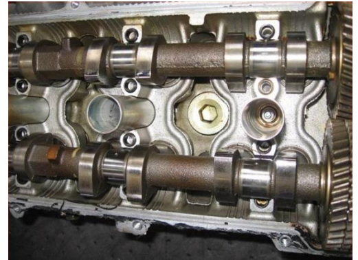
定期的にオイル交換を行っている平成 9 年式エステマ・ルシーダ (トヨタ) のエンジン内部 (13 万キロ走行)
