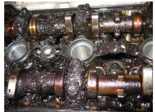
2 万キロオイル交換を行わず破損した平成 14 年式ガイア (トヨタ) のエンジン内部 (13 万キロ走行)
