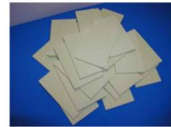
図1 実用スパッタ装置搭載用焼結ターゲット 開発したB-Ga-ZnO焼結ターゲット。実験用では丸型、実用機用では角型ターゲットが使用されている。
