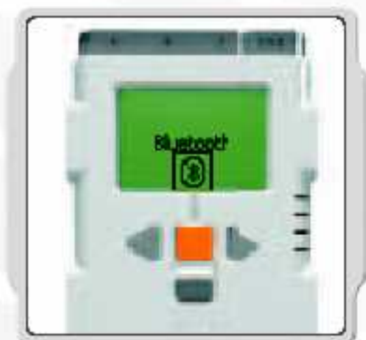
Bluetooth (ブルートゥース) NXT画面でBluetoothサブメニューを選択します。
