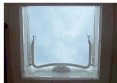
Pour ouvrir le lanterneau, il faut pousser sur le bouton de verrouillage pour libérer la poignée et la tirer vers le bas. Ensuite, la tirer vers soi pour la caler sur l'un des trois crans d'ouverture.
