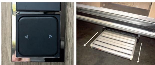
Pour le rentrer, appuyer sur la flèche de droite. En cas d'oubli, le marchepied rentre automatiquement au moment du démarrage du moteur.
