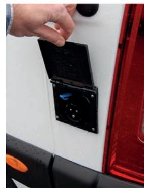
Le courant 230 V alimente les prises intérieures et le chargeur de batterie.
