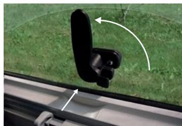
Pour ouvrir la fenêtre, déverrouiller les poignées en appuyant sur le bouton, puis les tourner vers la gauche jusqu'à ce qu'elles soient complètement à la verticale.
