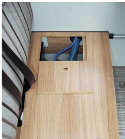
Votre camping-car est équipé d'un réservoir rigide d'eau potable d'une capacité de 100L situé sous la banquette passagers.
