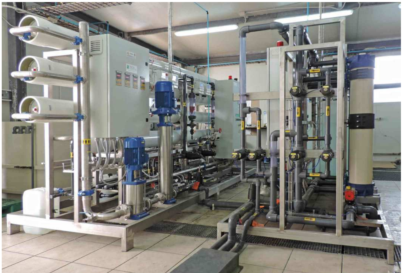
Nanofiltrazione 30 mc/h per riciclo scarichi con doppio passo permeato e doppio stadio concentrato
