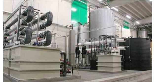
Nanofiltrazione con pretrattamento di Ultrafiltrazione
