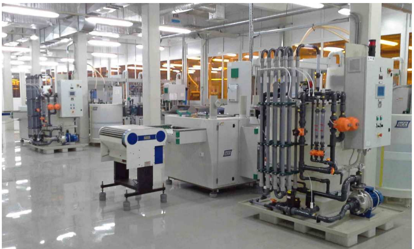
Ultrafiltrazioni per il riciclo dello sviluppo D/F in reparto circuiti stampati
