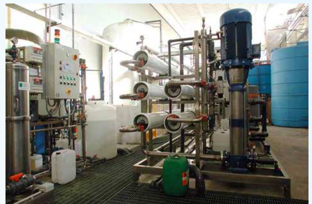
Impianto di osmosi inversa riciclo scarichi 25 membrane - 15 mc/h
