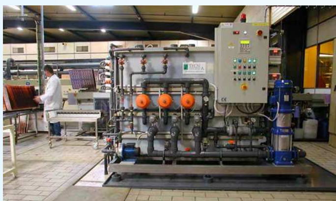
Impianto ultrafiltrazione sviluppo dry/film – 400 lt/h
