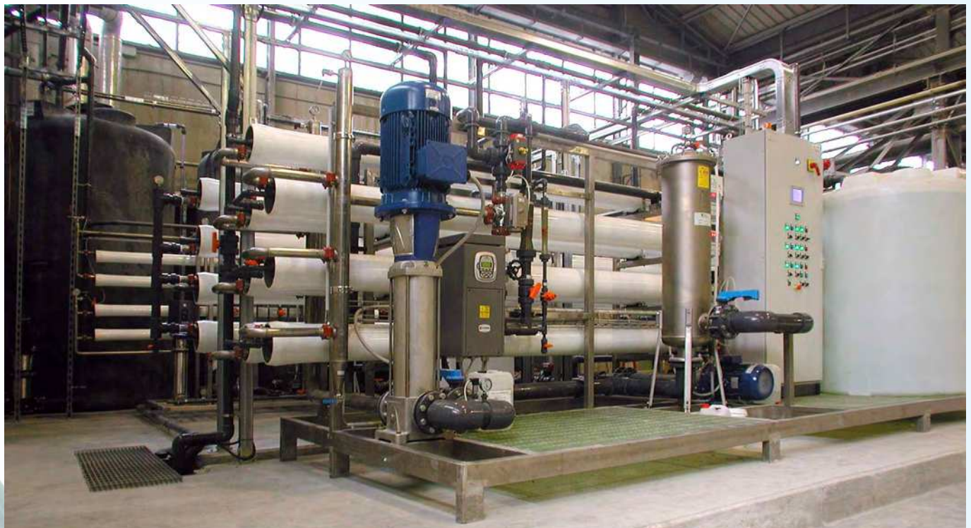
Impianto di osmosi inversa riciclo scarichi 25 membrane - 15 mc/h
