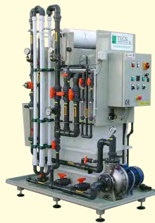
Ultrafiltrazione stripping dry/film con filtro a carta
