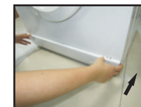
Visser le couvercle de pompe. Fermer le panneau de service.
