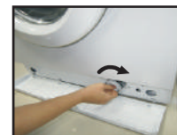
Visser le couvercle de pompe. Fermer le panneau de service.
