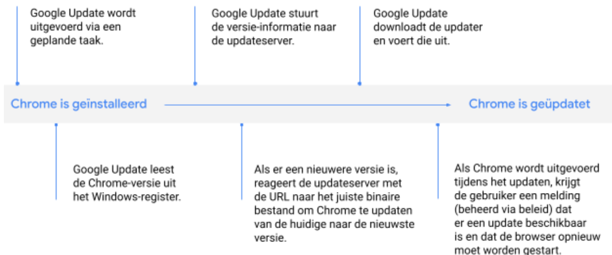
Afb. 3: Hoe een bestaande Chrome-installatie automatisch wordt geüpdatet door Google Update.
