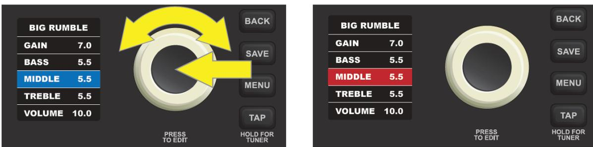
El control puede ajustarse girando el ENCODER o girando el botón de control físico correspondiente en el panel de control (cuando esté presente\*):
