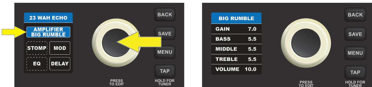
Hay dos maneras de ajustar el ajuste del botón de control de un amplificador. Puede ajustar un parámetro de control que corresponda a un botón físico real en el panel de control tan solo girando el botón de control físico hasta que el valor deseado aparezca en la PANTALLA DE VISUALIZACIÓN. En el ejemplo que se muestra a continuación, el valor MIDDLE del modelo de amplificador se ajusta girando el botón de control MIDDLE en el panel de control:
