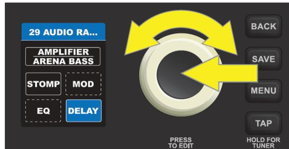
La PANTALLA DE VISUALIZACIÓN mostrará una lista de controles para el modelo de efecto que se utiliza en esta categoría; utilice el ENCODER para desplazarse hasta un control del efecto concreto. Pulse el ENCODER para seleccionar el control del efecto; su cuadro de alrededor pasará de azul a rojo. Gire el ENCODER para establecer un nuevo valor para el valor de control seleccionado:
