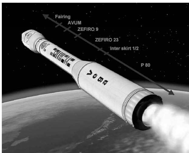
Figura 24. Configurazione del lanciatore Vega (Cortesia Avio).
