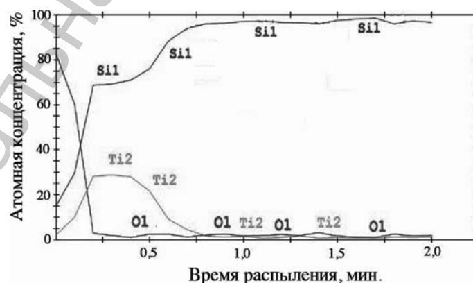
Рис. 1. Профили концентраций элементов по времени для гетероструктуры TiN/Ti/Si, прошедших двухступенчатую БТО
